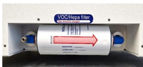
12.3. attēls. Pareizi uzstādīts VOC/HEPA filtrs
