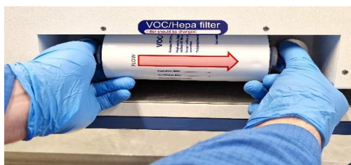
12.2. attēls. VOC/HEPA filtra ievietošana un izņemšana
