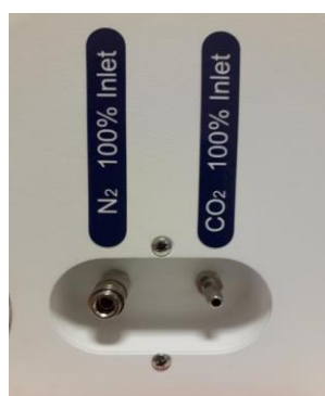
11.1. attēls. Gāzes ieplūdes MIRI ® un MIRI ® Humidity daudznodalījumu IVF inkubatora aizmugurē
