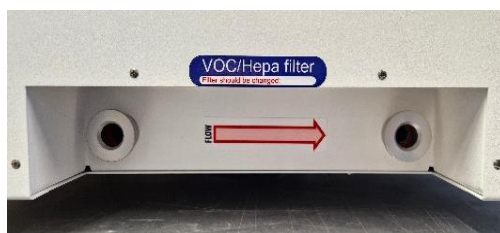
12.1. attēls. Plūsmas bulta uz MIRI ® daudznodalījumu IVF inkubatora
